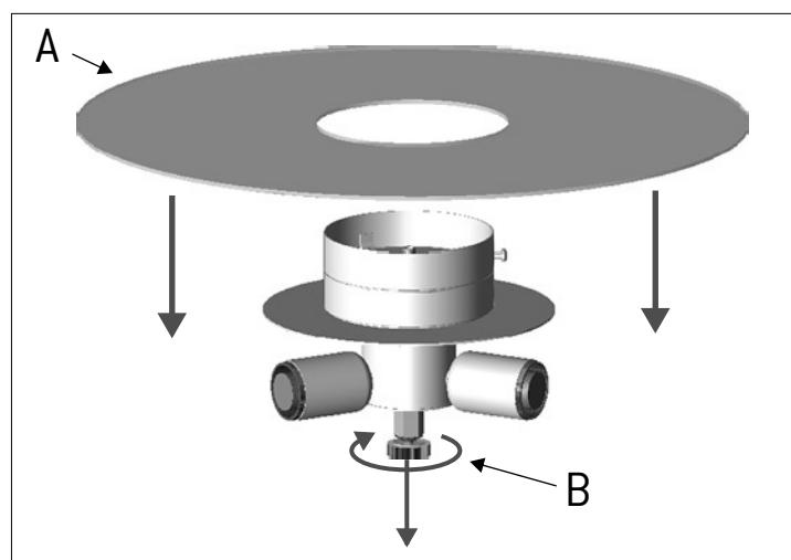
3- Conectar los cables. Asegurarse de conectar correctamente el cable tierra. Fijar el conjunto a la sujeción mediante el tornillo lateral (figura 4). Figuras 3,4 y 5.
