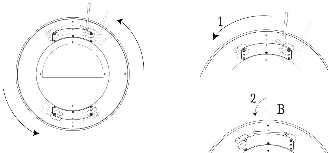
5. Abrir los seguros (B) de la parte trasera. Encajar las chapas de giro (C) en los soportes atados previamente (A). Girar la luminaria hasta el tope para que quede bien sujetada. Cerrar el seguro (B).
