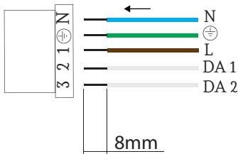
Para conectar los cables de tensión, abra la sujeción mediante destornillador de 2,5mm e inserte después los cables hasta el tope. Quite el destornillador y el cable quedará fijo. Para cables rígidos, no hace falta el destornillador.
