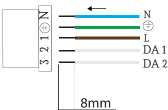
Para conectar los cables de tensión, abra la sujeción mediante destornillador de 2,5mm e inserte después los cables hasta el tope. Quite el destornillador y el cable quedará fijo. Para cables rígidos, no hace falta el destornillador.
