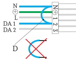
Para soltar o conectar los cables de tensión, abra la sujeción mediante destornillador de 2,5mm, saque o inserte después los cables. Al quitar el destornillador el cable quedará fijo. Para cables rígidos, no hace falta el destornillador.
