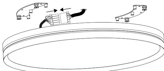
3. Fijar los dos soportes (A) en los tacos, mediante las arandelas y los tirafondos suministrados.
