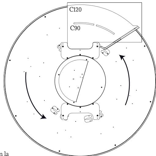
5. Abrir el seguro (B) de la parte trasera. Encajar las chapas de giro (C) en los soportes atados previamente (A). Ayudarse para posicionar la luminaria con la plantilla (E). Girar la luminaria hasta el tope para que quede bien sujetada. Cerrar el seguro (B). Retirar la plantilla (E).
