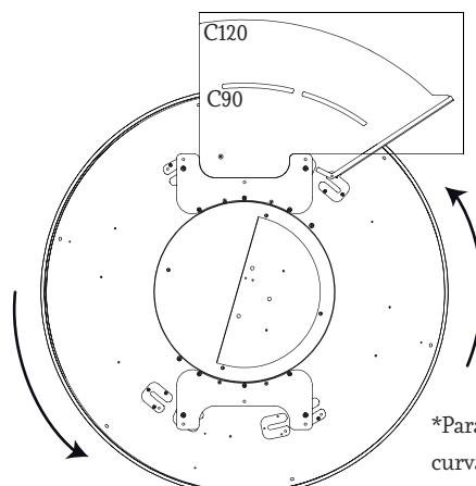
\*Para posicionar hacer coincidir la luminaria con la curva del dibujo y con el seguro B.
