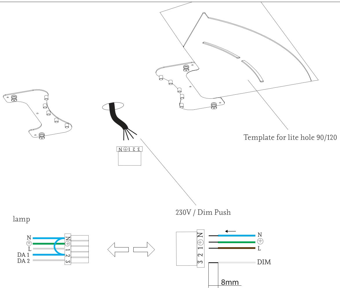
3. Fijar los dos soportes (A) en los tacos, mediante las arandelas y los tirafondos suministrados.
