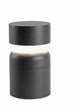
Baliza de estilo moderno con tecnología LED para iluminación exterior, fabricada en aluminio inyectado con difusor de PC opal. La fuente de iluminación es SMD LED 6W 3000K 155Lm. Esta baliza es ideal para la iluminación decorativa del jardín por el haz de luz circular que proyecta, creando un bonito efecto lumínico.
