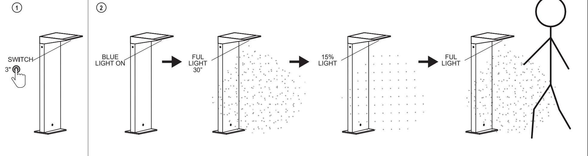
• **ESP** CONSIDERACIONES PREVIAS el área de detección que muestra el dibujo es el obtenido bajo el supuesto de colocación del sensor en condiciones óptimas, detectando un persona de complexión normal i una altura d'1,80m.
