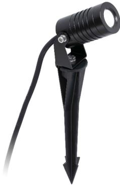
Proyector LED con estaca de luz cálida para exteriores fabricado en aluminio con difusor de cristal transparente. La fuente de iluminación es HIGH POWER LED 3W 3000K 130Lm 36° CRI>80. Este proyector orientable es ideal para la iluminación del jardín y le permitirá realzar elementos decorativos. Esta luminaria cuenta con IP67 que le otorga una alta protección contra la lluvia y los cuerpos sólidos.
