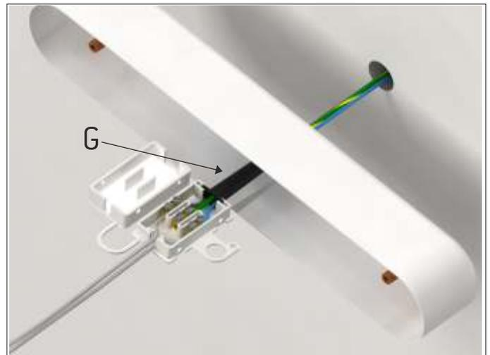
7- Introducir la manguera del conector en el interior de la pared. Figura 7.
