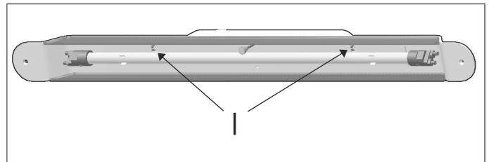
10- Acoplar la pantalla (B) a la lámpara y fijarla con las arandelas grafiladas (A) liberadas previamente. Figura 10.
