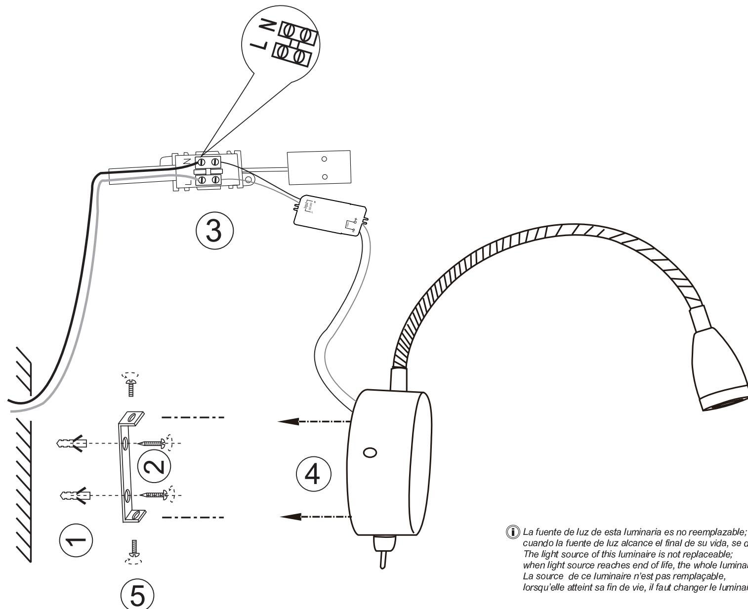
**i** La fuente de luz de esta luminaria es no reemplazable; cuando la fuente de luz alcance el final de su vida, se debe sustituir la luminaria completa.
