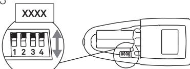
Choose the fan working frequency using the switches you can find in the remote control. Seleccionar la frecuencia de trabajo del ventilador mediante los 4 pines que pueden encontrar dentro del compartimento de las pilas del mando.
