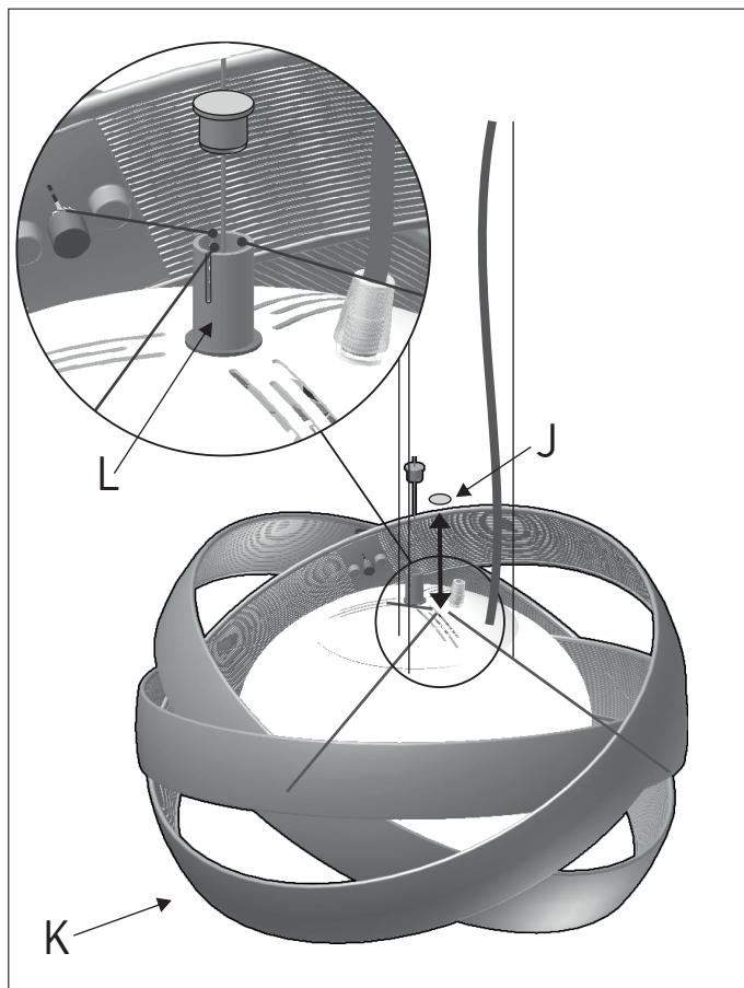
10- Nivelar la lámpara a la altura deseada desplazando el cable de acero hacia arriba o hacia abajo. Ver funcionamiento de los pinzacables en la nota que se adjunta a continuación. Figura 10.
