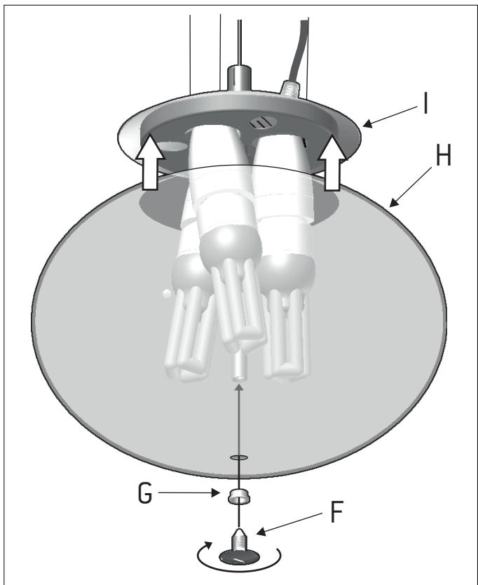
8- Vidrio de fabricación artesanal, lo que puede conllevar una posible distribución del material no uniforme. Si el vidrio queda inclinado, aflojar ligeramente el tornillo (F) y ajustar la desviación. Volver a enroscar el tornillo (F) una vez nivelado. Figura 8.
