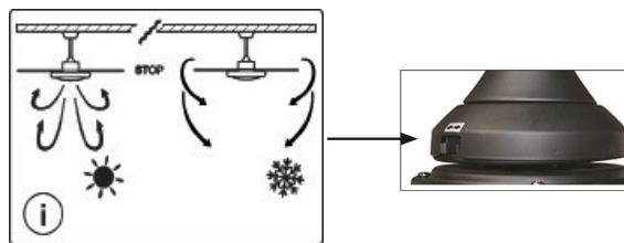
Door de stijgende luchtcirculatie wordt de warme lucht in de buurt van het plafond bewogen, zoals wordt aangegeven op afbeelding. Zo kan de verwarming ingesteld worden op een lagere temperatuur, zonder dat hierbij moet inboeten aan comfort.
